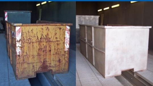
Optimale Reinigung sorgt für beste Lackierergebnisse (links vorher, rechts nach Reinigung)
